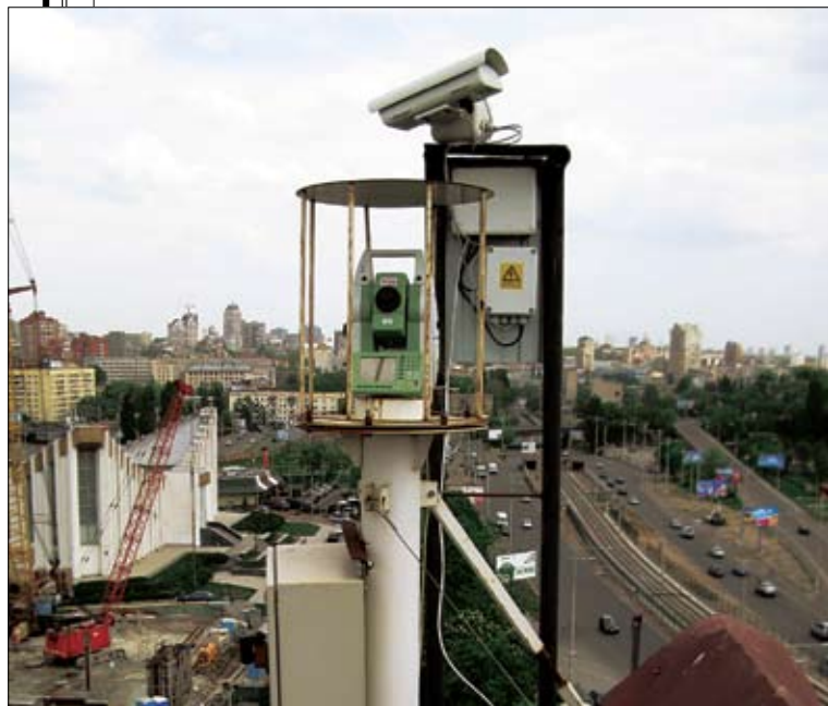
Еще один роботизированный тахеометр на крыше здания
